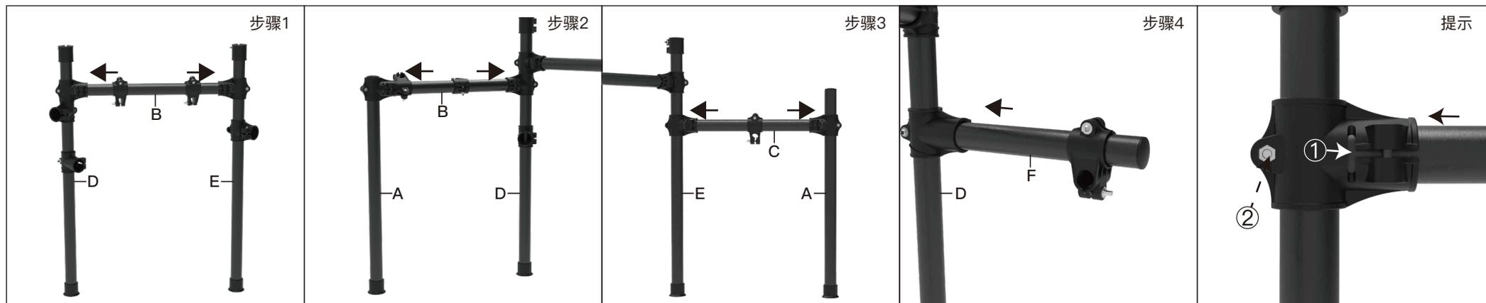
提示：支架应插入至可见底部如图①所示，安装完毕并调节至合适位置后，再紧固每个螺杆（图②为螺杆）。
