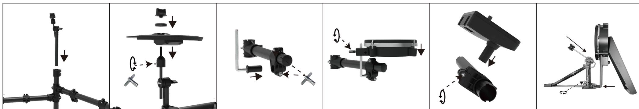
提示：将镲片放置在立柱上，注意镲心凹槽与立柱凸起咬合。晃动镲片，检查镲片是否与立柱咬合；检查镲片打击区域位置是否正确，若不正确，则松开立柱，调整方向再次拧紧。
